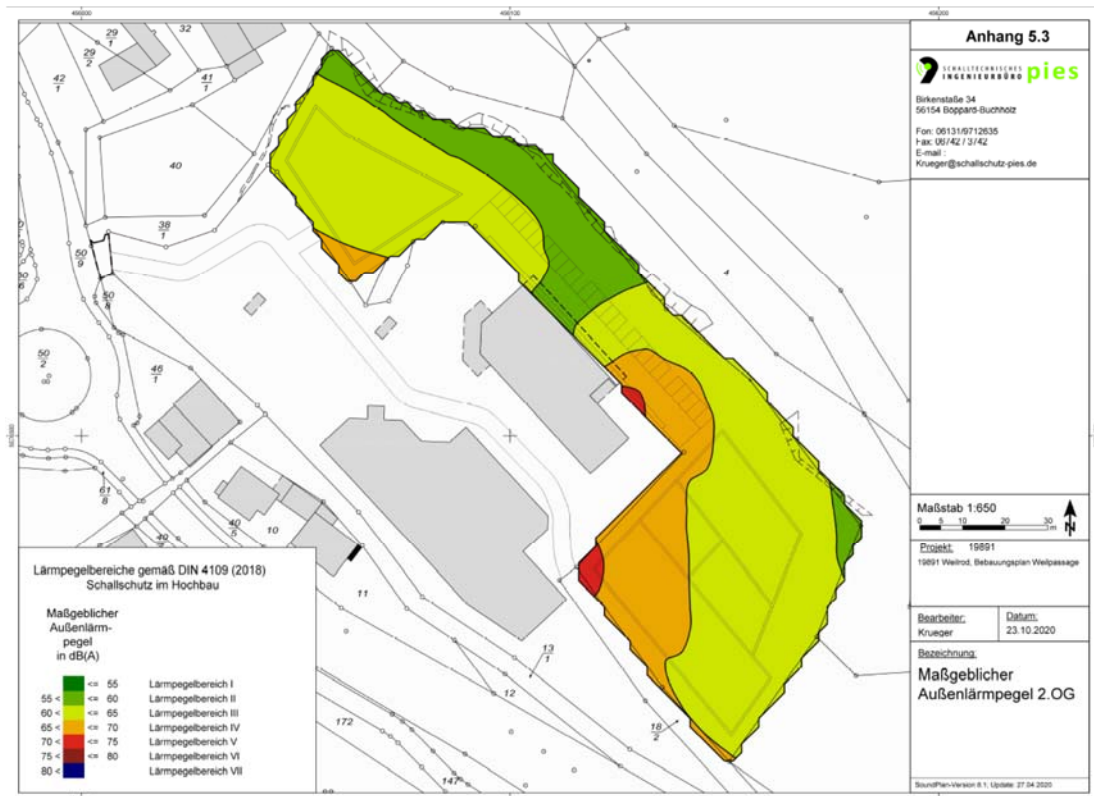
Abbildung: Maßgeblicher Außenlärmpegel und Lärmpegelbereich nach DIN 4109
